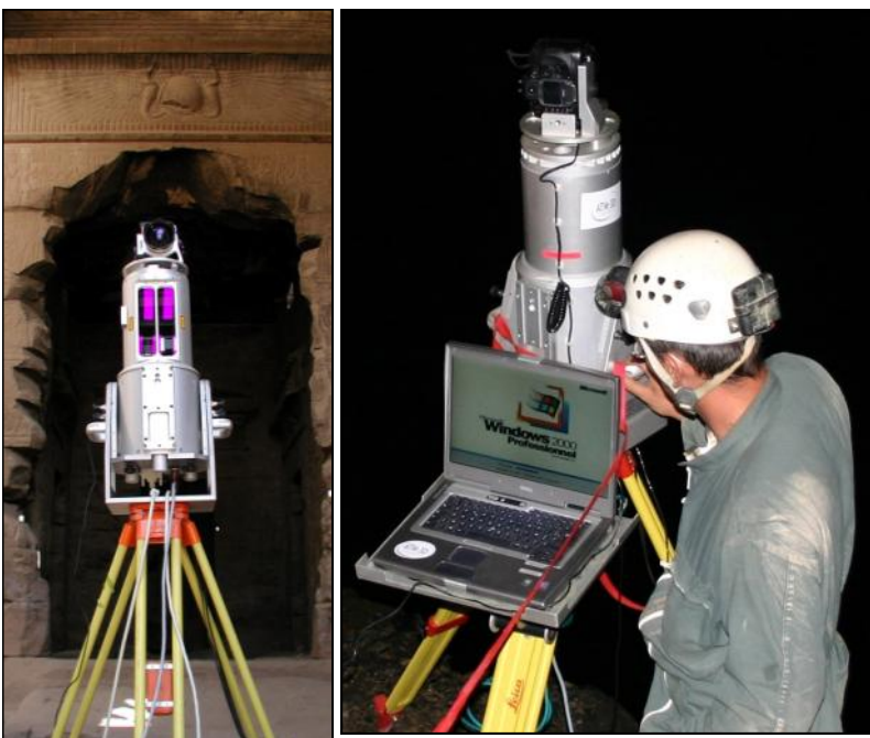
Ici à Karnak et au gouffre de la Pierre Saint-Martin, les scanners-lasers Riegl Z390 et 4210, avec caméra Nikon pour mieux adapter le semis de points à l'image,
