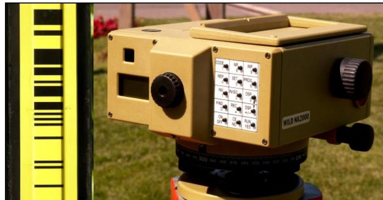
Le Leica NA2000 et sa mire code-barres, premier niveau numérique apparu sur le marché.
