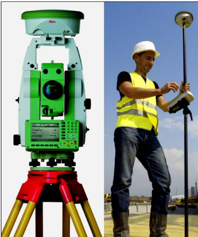
A gauche la solution LEICA avec le GPS sur la station totale. A droite la solution Trimble pour une implantation.
