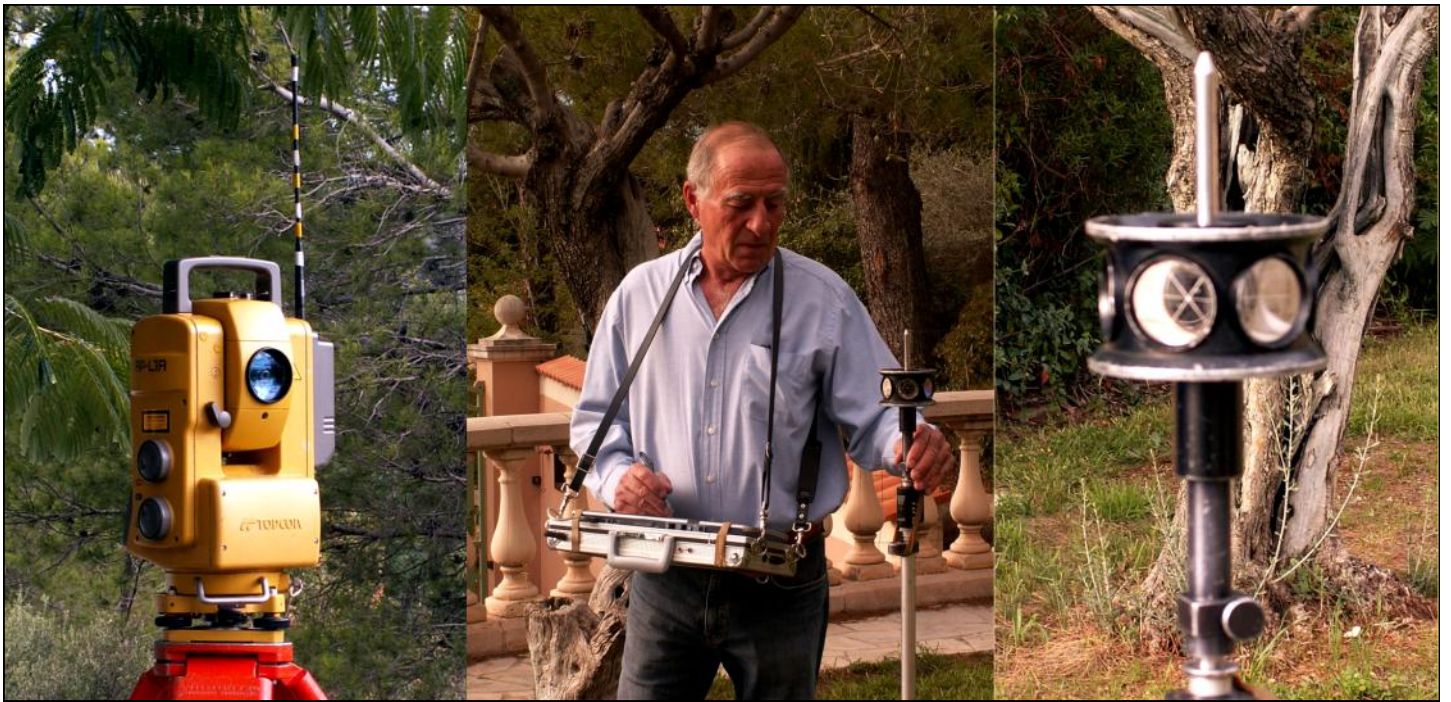
Une station motorisée Topcon A8-L1A de 1999 qui suit automatiquement le prisme en mouvement. L'antenne permet la liaison avec l'opérateur qui peut dessiner en temps réel son lever en DAO.
