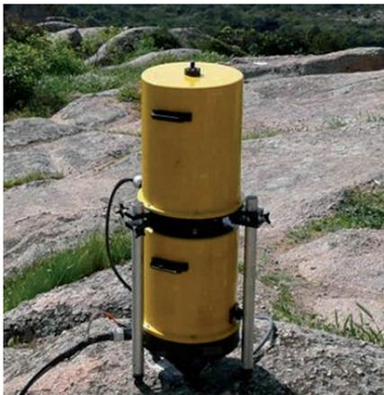
Le **A10** acheté par l'IGN en 2005, en partenariat avec l'Institut de Recherche pour le Développement et l'Institut de Physique du Globe de Paris (IPGP) est un gravimètre absolu Micro-g A10, d'une précision inférieure à  $10^{-8}$ . Il fonctionne lui aussi sur le principe de la chute libre dans le vide d'un objet (coin de cube en céramique).
