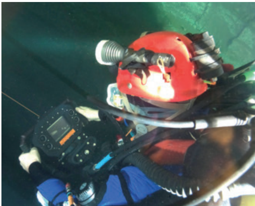
Essai du Cobra Tac, conduit par le plongeur à Port Miou. On distingue en dessous le fil d'Ariane suivi à vue par le plongeur.
