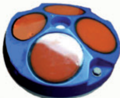
Le transducteur, placé sous le Cobra Tac, qui émet les faisceaux acoustiques et réceptionne leurs échos.
