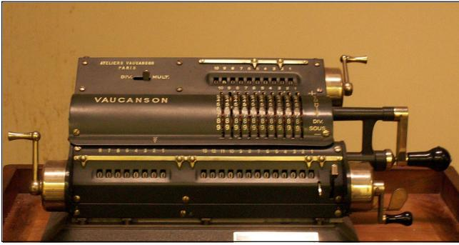
**Fig. 8 :** a machine à calcul Vaucanson utilisée à l'IGN jusque dans les années 1970. On pouvait introduire jusqu'à 10 chiffres significatifs et obtenir des résultats à 13 chiffres
