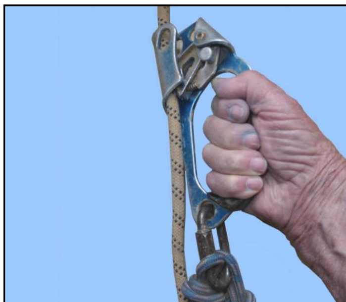
En haut, la poignée Petzl qui améliore le jümar. En bas, le spéléologue pousse avec un ou deux pieds dans la longe reliée au jümar pour progresser. Le frein Dressler l'empêche de redescendre
