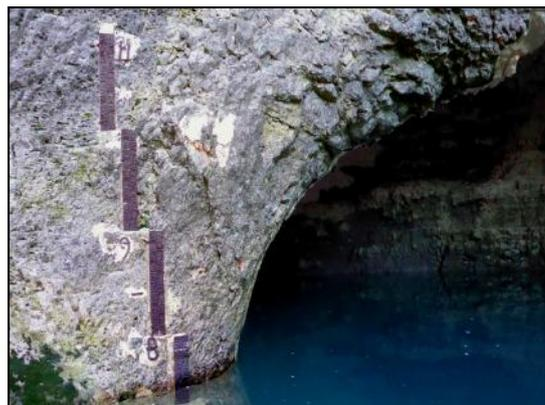
**Nota :** Le niveau de l'eau pouvant varier, la profondeur des plongées doit être ramenée au zéro du Sorgomètre qui correspond au niveau de l'étiage les années très sèches.
