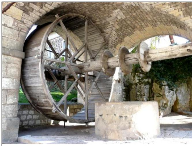
roues à poignée axées sur le tambour en bois où s'enroulait la corde ; des grandes roues placées en hauteur et axées sur le tambour, elles étaient actionnées par une chaîne à laquelle on se suspendait ; des roues avec démultiplication qui permettaient de remonter de plus lourdes charges, mais plus lentement.
