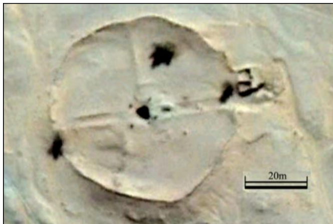
A Bir Jidliya, obstrué à -7 m, subsiste l'aire de halage des chameaux puisant les outres. Tenu compte du retournement des chameaux, l'eau était à 18 m de profondeur.
