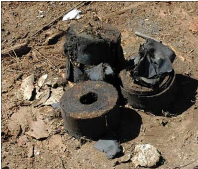
fig 39 : Rouleau de goudron pour les joints de toiture (ph. J.F. Le Mouël)
