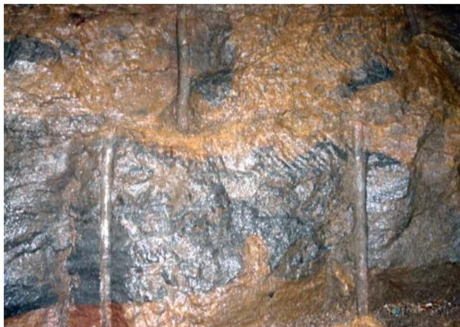
**A Besançon, ces trois forures se sont concentrées sur un banc de roche dure. Le 1,4 litre de poudre qu'elles contenaient a dégagé combien de m<sup>3</sup> de CO<sub>2</sub>?**
